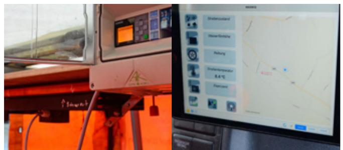
*Dies ist die Steuerung des Marwis Straßensensors für den Glättemeldesensor im Heck ihres automatisierten Stramot-Fahrzeugs*
